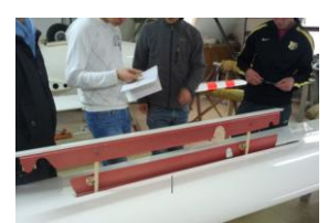
Matériaux et structure. Etude des aérofreins
